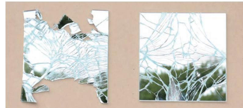
左：通常ミラー 右：フロントフィルムコーティング加工後のミラー
